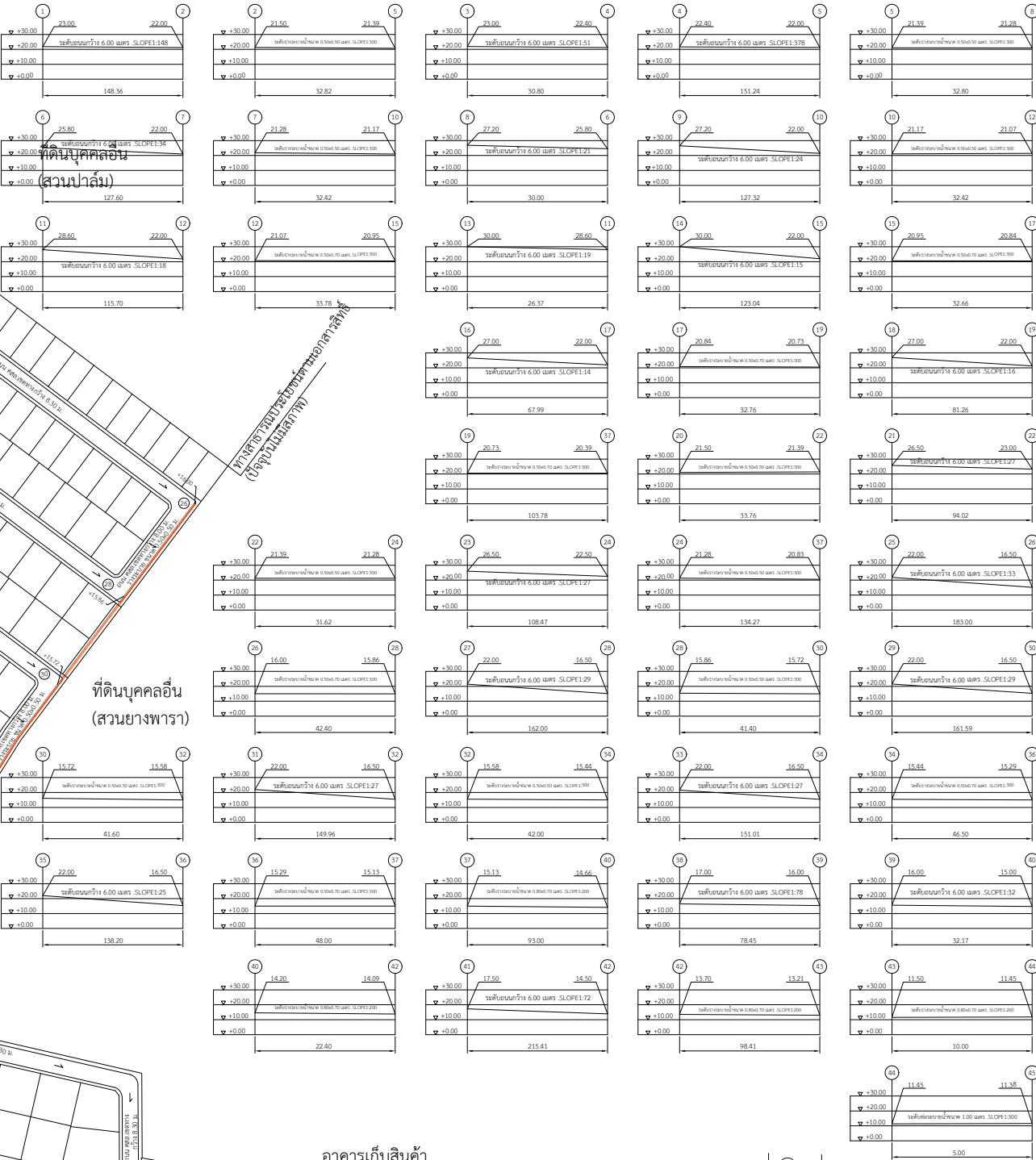
แบบขยาย PROFILE ท่อระบายน้ำฝน
